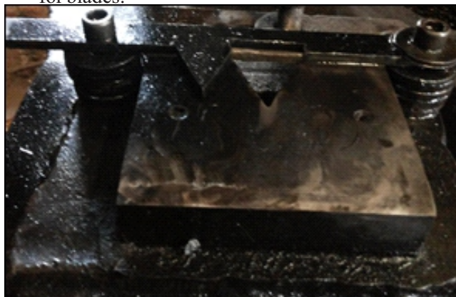
Fig. 4. Die used for blanking
